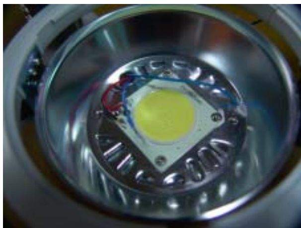
LED & 燈殼 溫度測試點
